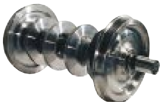
Essieu monté porteur du TGV, équipé de quatre disques de frein
