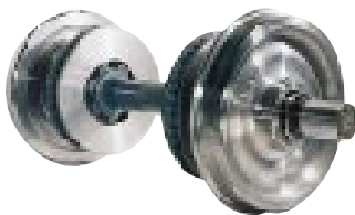
Essieu monté équipant les navettes d'Eurotunnel
