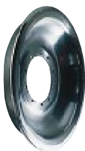
Roue de sécurité des métros sur pneumatiques. Elle assure une fonction de freinage et de portage en cas de crevaison.
