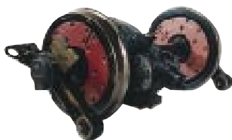
Essieu monté moteur avec réducteur et disques de freins flasqués sur les roues.
