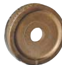
Ebauche forgée d'engrenage
