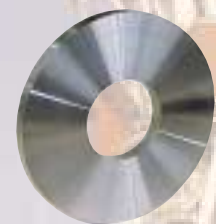
Disque de frein de TGV à haute énergie
